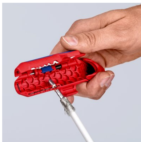
Удаление изоляции с коаксиального кабеля
